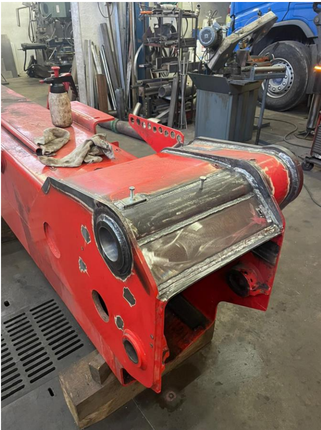
Kuva 3. Korjatun puomin tyviosa
