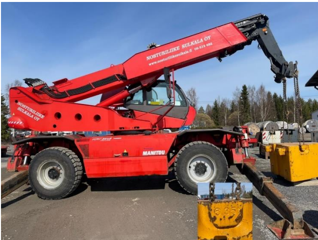
Kuva 1. Korjattu kurottaja ylikuormituskokeessa
