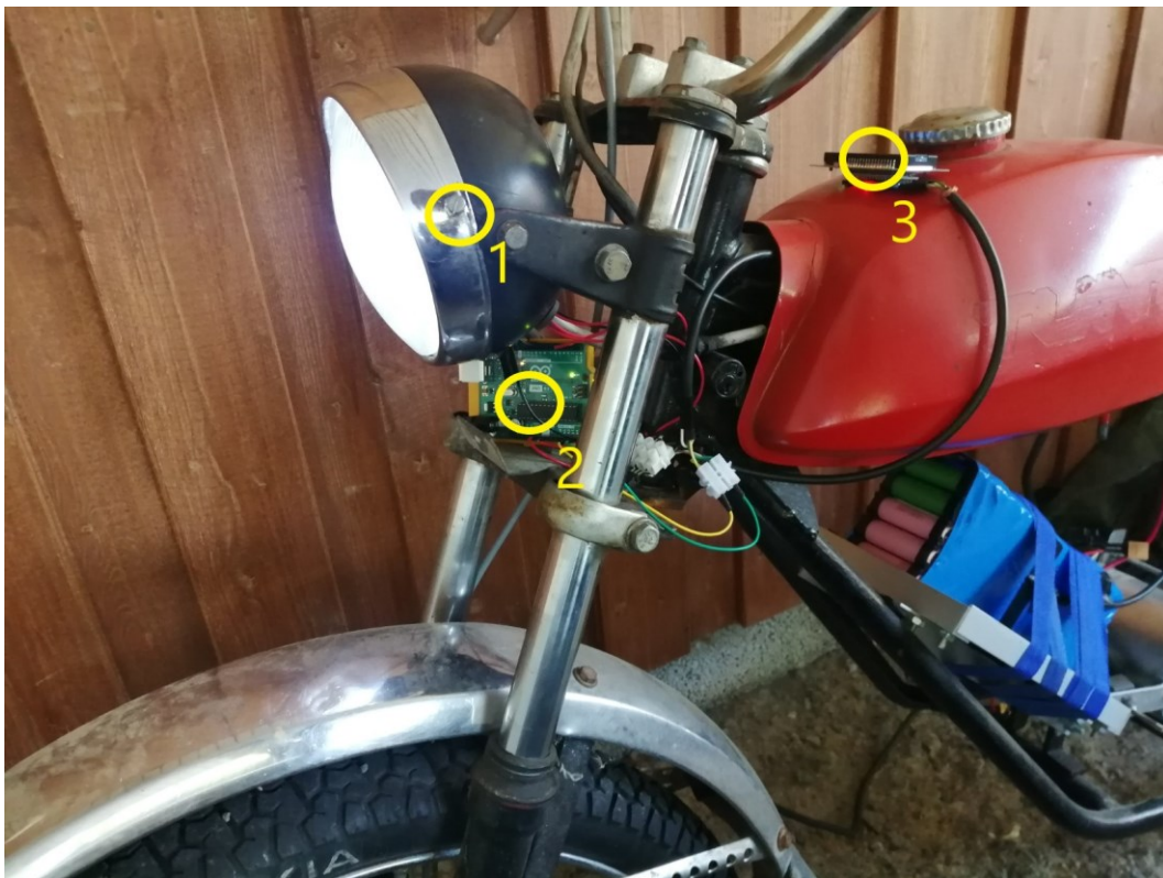
Kuva 18. Väylän toinen pää. (1) Rele umpion sisällä (2) Arduino 1 (3) LCD-näyttö
