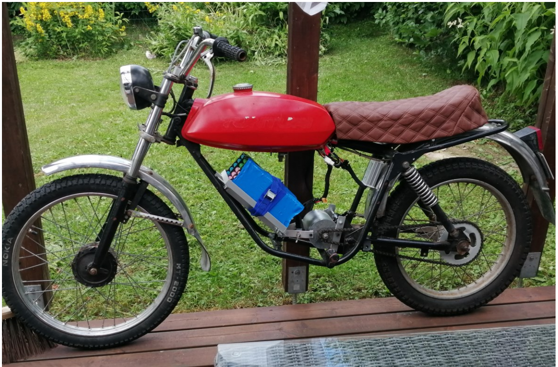
Kuva 5. Tunturi-mopo sähkökonversion jälkeen.
