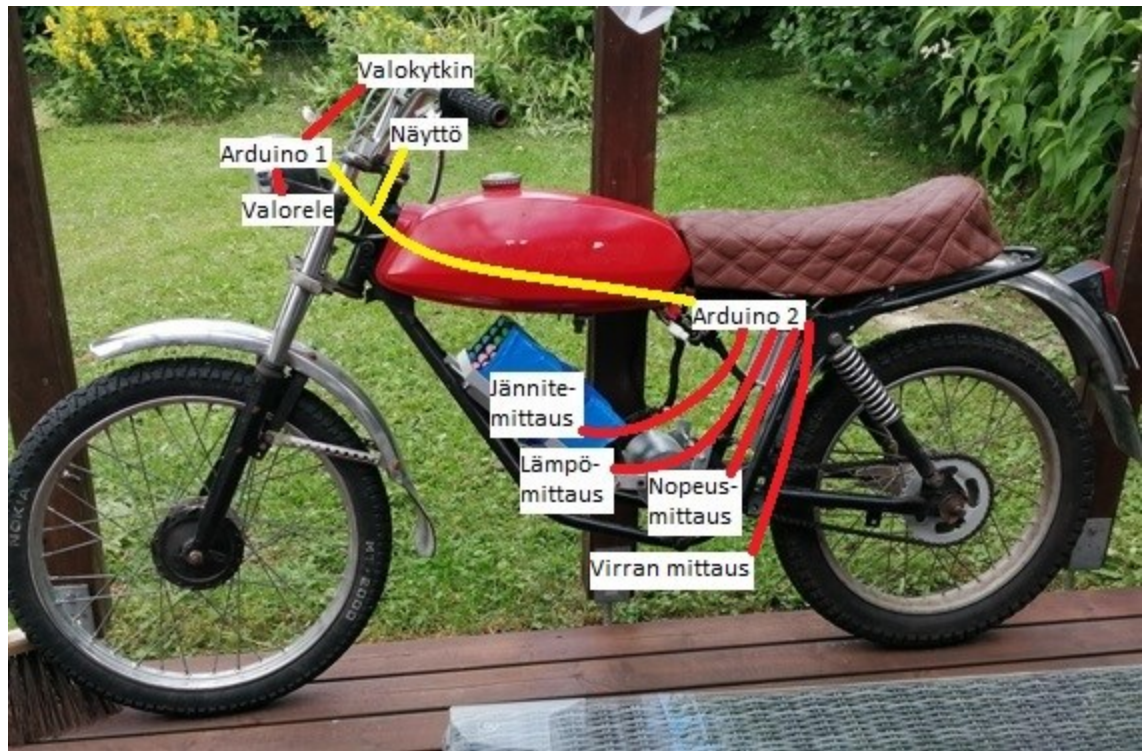
Kuva 7. Väylän suunniteltu reitti ja toimilaitteiden sijainnit.
