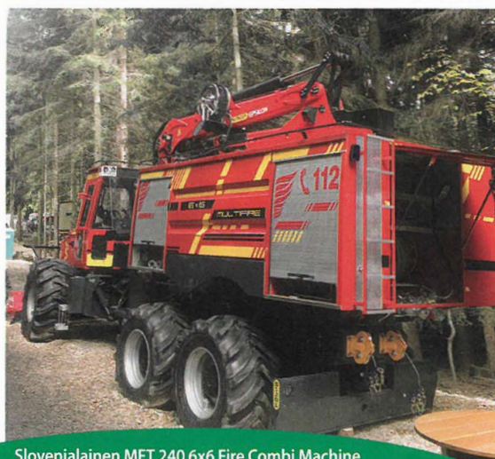
Slovenialainen MFT 240 6x6 Fire Combi Machine metsäpalojen sammutukseen.
