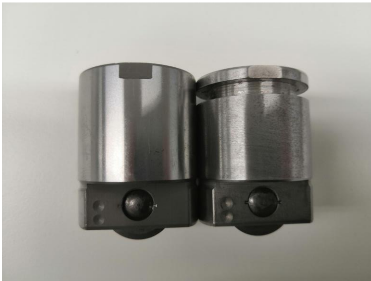
Kuva 15. Tuotannossa käytettävä etumäntä vasemmalla ja prototyypimäntä oikealla (Kuva: Väinö Kosonen).
