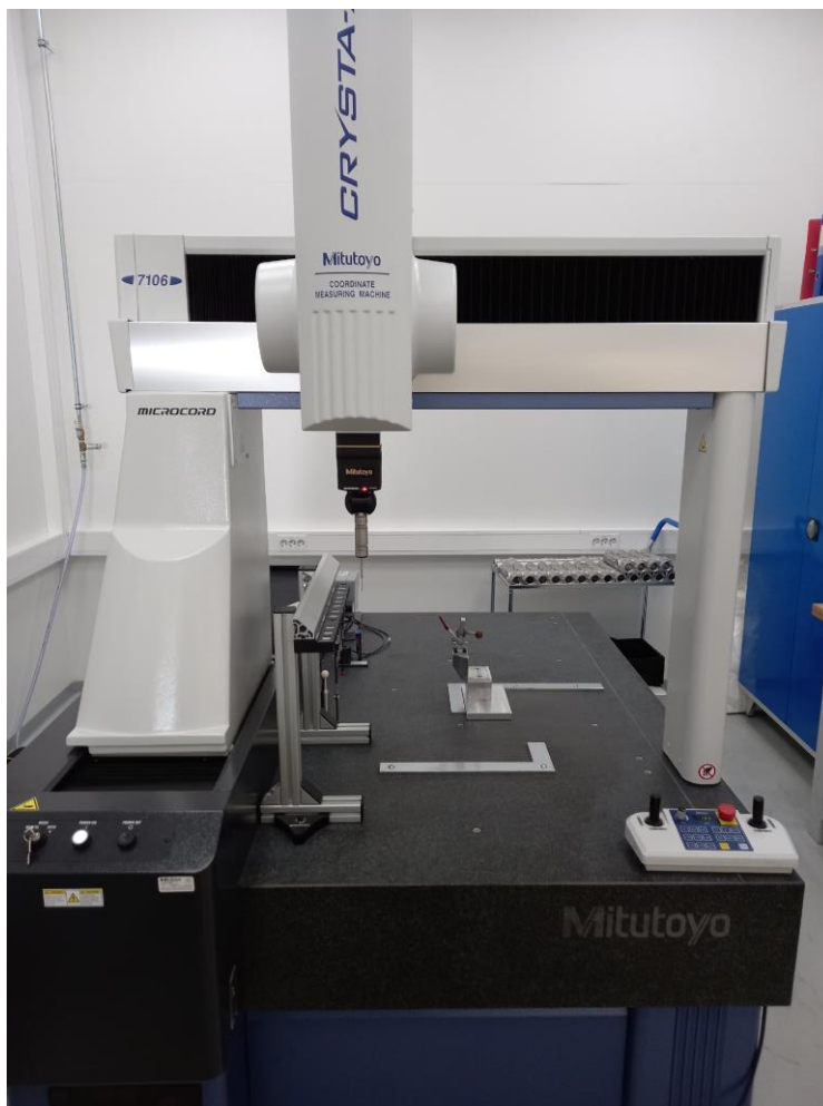
Kuva 14. Tuotannossa käytettävä koordinaattimittakone ja paikoitus jigi (Kuva: Väinö Kosonen).
