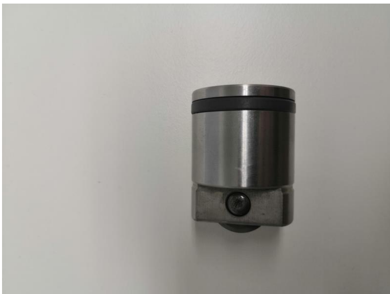
Kuva 16. Prototyypisulkimessa käytetty tiivisteellinen mäntä (Kuva: Väinö Kosonen).
