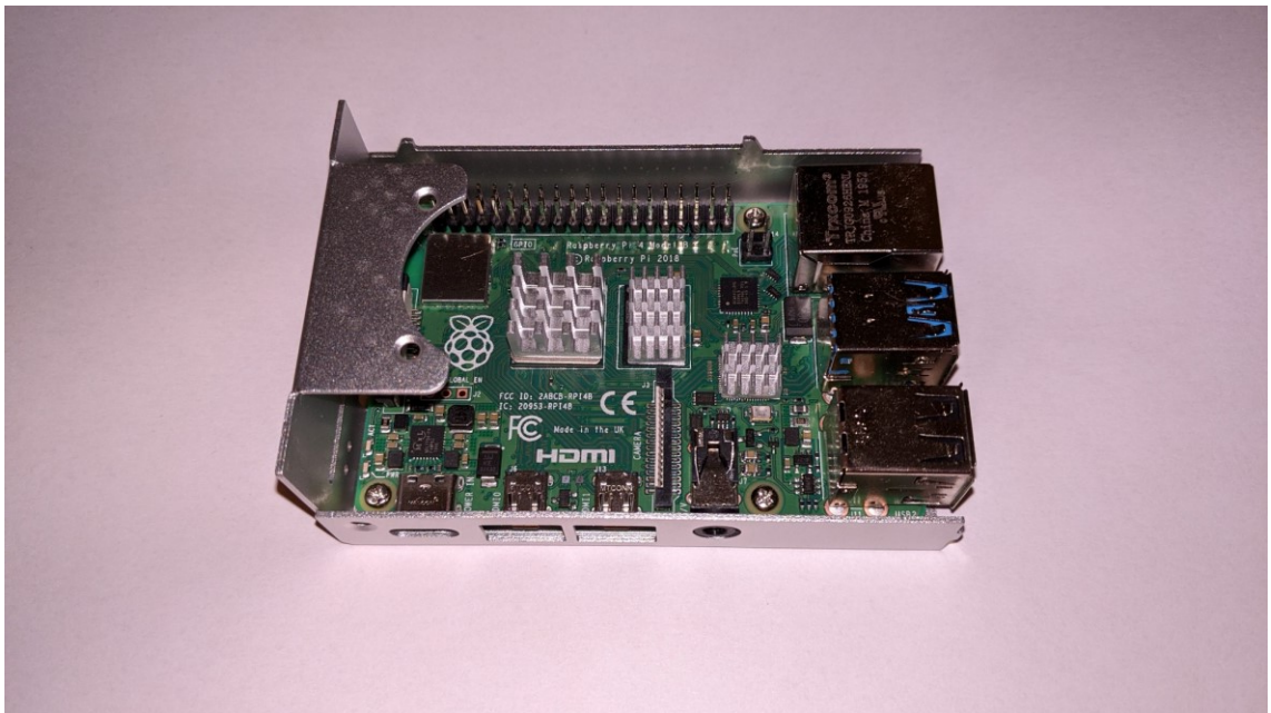
Kuva 3. Raspberry Pi 4 B jäähdytysseilit kiinnitettynä ja asennettuna OKdon suojakoteloon.
