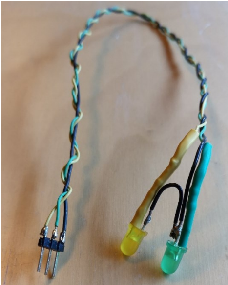
Kuvio 13. Mittalaitteen LEDien ja mitoitettujen etuvastuksien kytkentä
