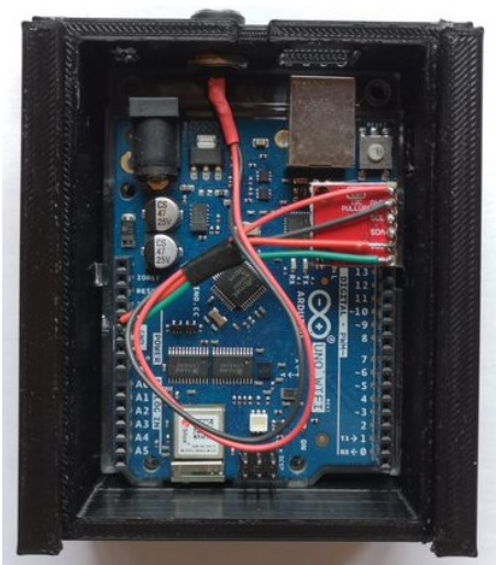
Kuvio 19. Vastaanottimen DA-muuntimen kytkentä Arduinoon
