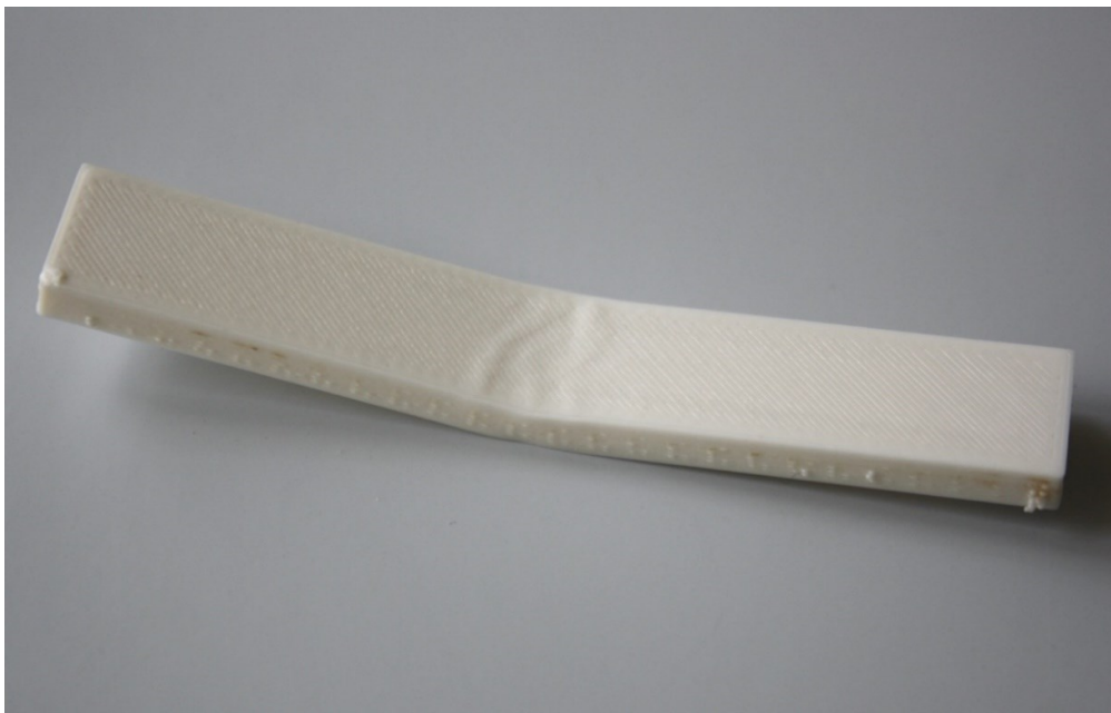
Kuva 12. Testikappaleen pinnan muutoksia puristusjännityspuolella.
