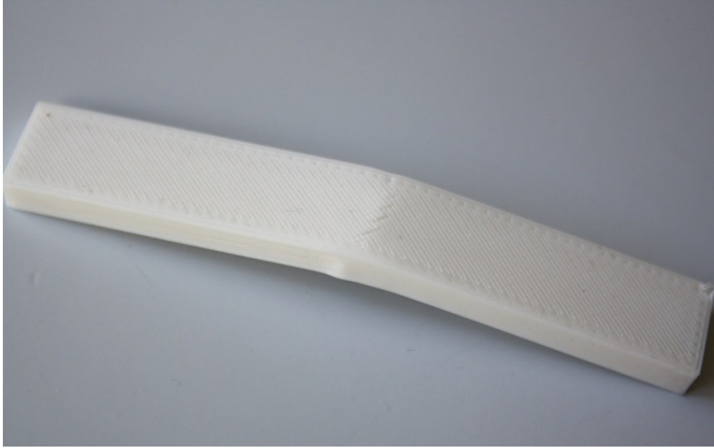
Kuva 13. Testikappaleen pinnan muutoksia vetojännityspuolella.
