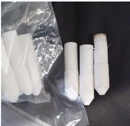
Kuva 15. PA12 muovista tulostetut suuttimet (kuvannut Robert Silvendoin).
