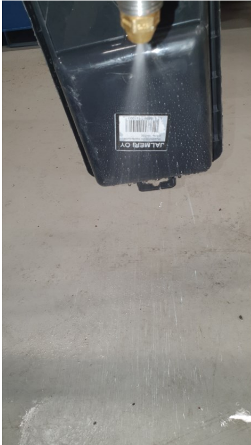
Kuva 9. Suuttimen suihku (kuvannut Robert Silvendoin).
