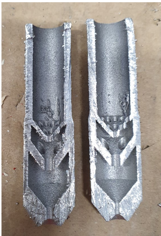
Kuva 31. Metallisuutin halkaistuna (kuvannut Robert Silvendoin).
