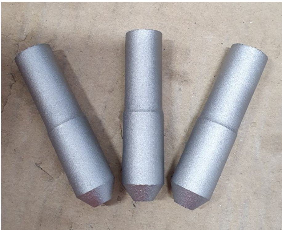
Kuva 28. Metallitulostetut suuttimet (kuvannut Robert Silvendoin).
