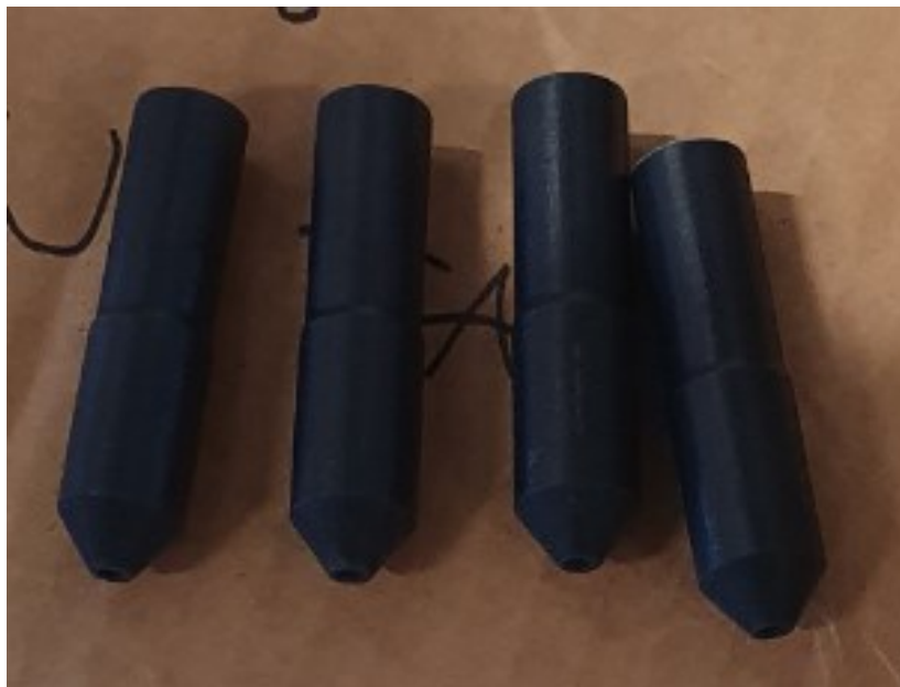
Kuva 19. Suutin 2 tulostettuna stereolitografisesti (kuvannut Robert Silvendoin).
