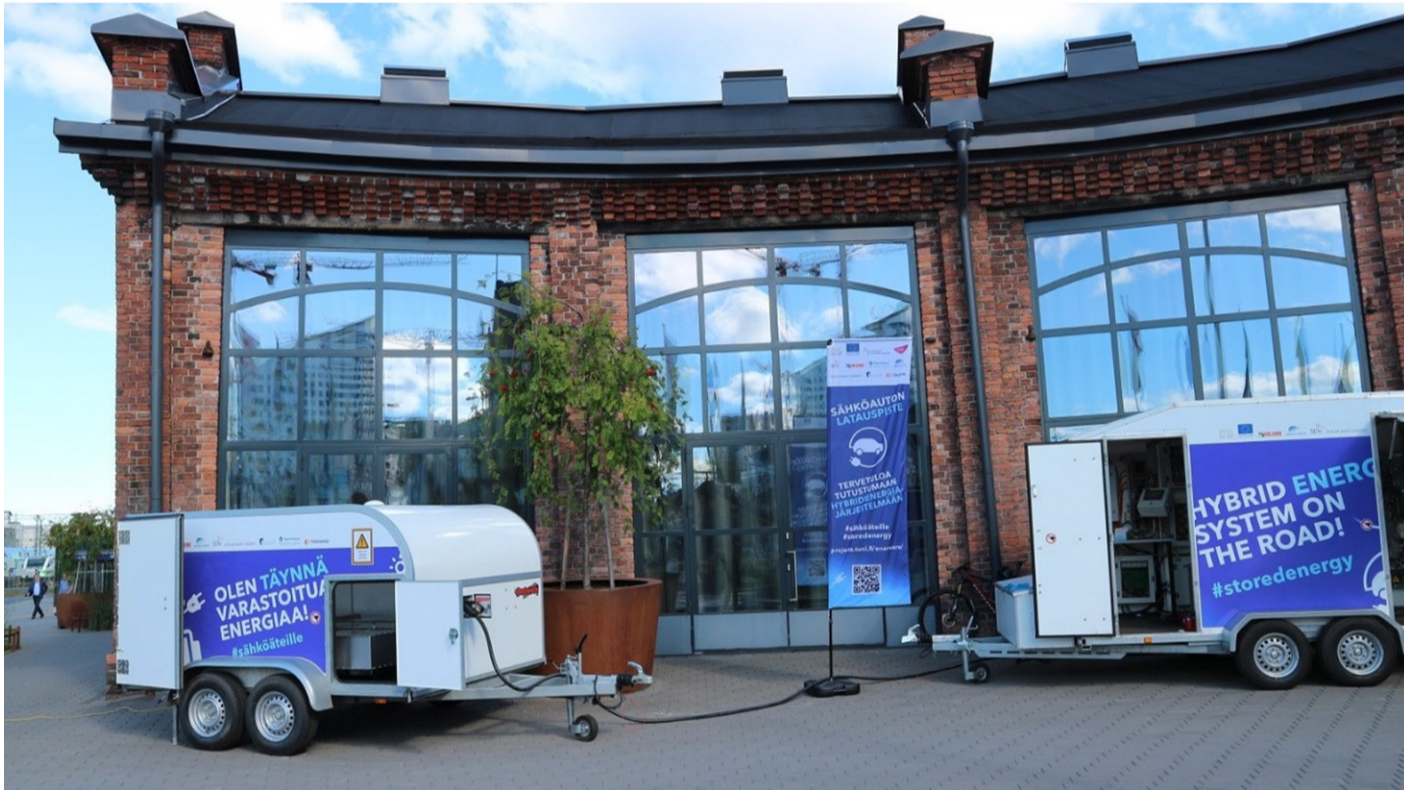
KUVA 1. Järjestelmällä voidaan ladata sähköautoja esimerkiksi niin, että osa tehosta otetaan sähköverkosta ja osa energiavarastosta. Kuvassa vasemmalla energiavarastovaunu ja oikealla teholinjavaunu.
