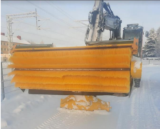
(Kuva 12 koneharja kaivinkoneessa)
