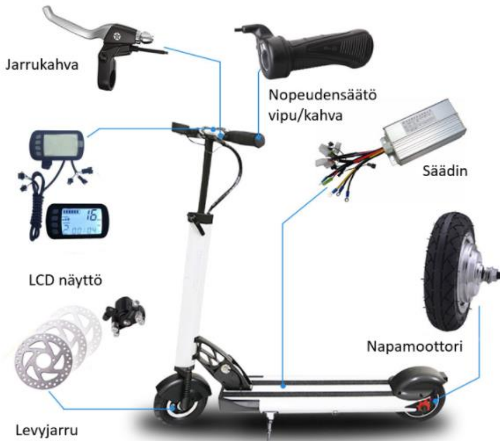
Kuva 1. Sähköpotkulaudan rakenne. (kuva: Kicker)
