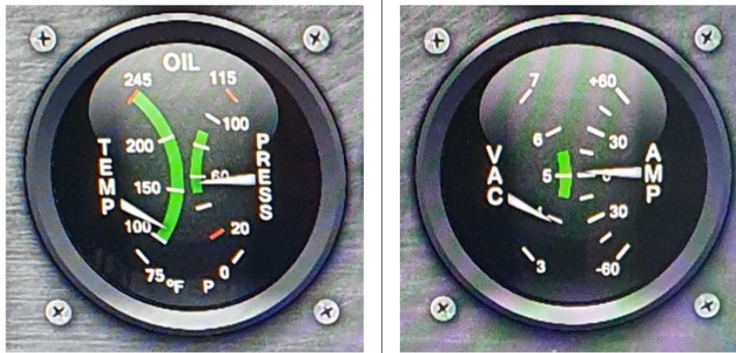
KUVA 19. Öljynlämpömittari ja -painemittari vasemmalla sekä tyhjiömittari (VAC) ja virtamittari (AMP) oikealla
