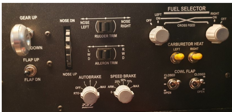
KUVA 26. Laippoihin, trimmaukseen ja moottorin toimintaan liittyviä kytkimiä
