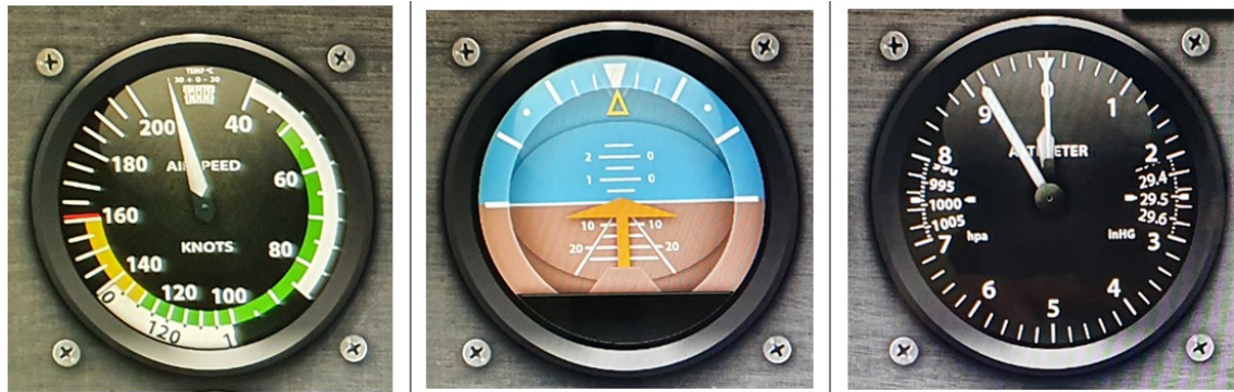
KUVA 14. Ilmanopeusmittari vasemmalla, elektroninen keinohorisontti keskellä ja korkeusmittari oikealla
