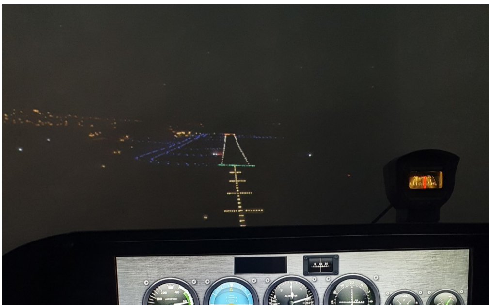
KUVA 31. Kiitotien lähestymis-, kynnyks- ja reunavalot sekä PAPI
