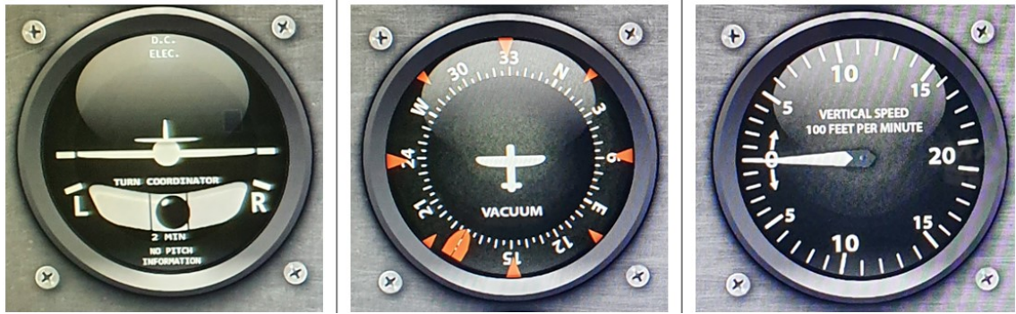
KUVA 15. Kaarto- ja luisumittari vasemmalla, hyrräkompassi keskellä sekä variometri eli pystynopeusmittari oikealla
