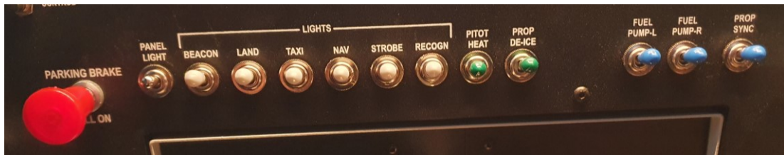
KUVA 25. Parkkijarru ja valo-, pitot-putken lämmitys- ja polttoainepumpunkytkimet
