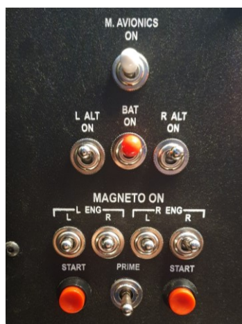
KUVA 24. Moottorinkäynnistyksen ja sähköjärjestelmien kytkimiä
