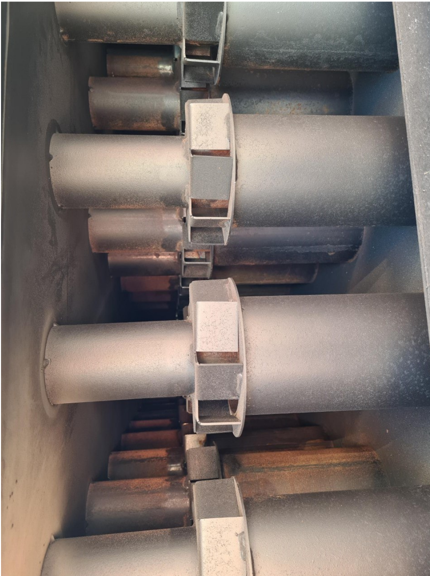
KUVA 14. Vastavirtasykloni aksiaalisella sisääntulolla
