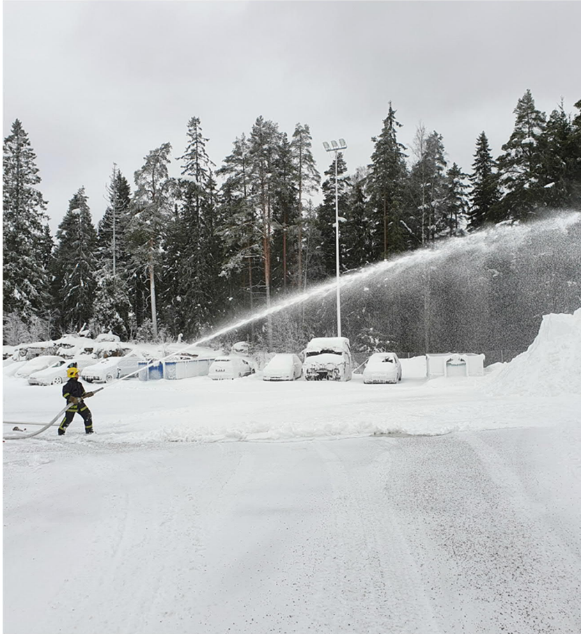
KUVA 9. CAFS-sammutusta järeällä työjohtoselvityksellä 3” suihkuputkella
