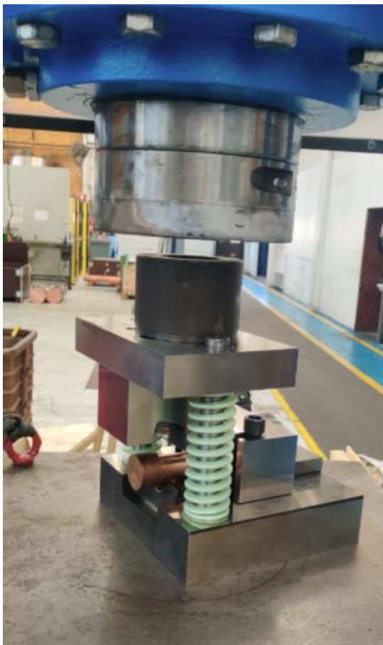
Kuva 22. Taivutin asetettuna hydraulikkapuristimelle.
