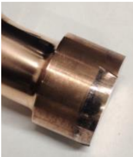
Kuva 24. Uusitulla Tuki 2 komponentilla taivutettu adapterin pää.
