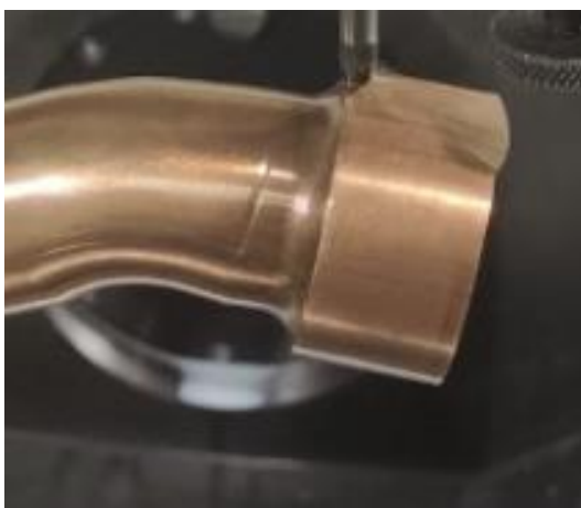
Kuva 23. Taivutuksen voimasta kasaan painunut adapterin kärki.
