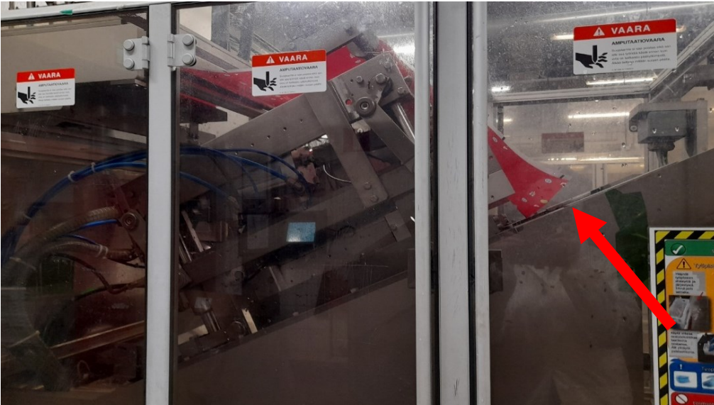
Kuva 13. Ensimmäisen testikerran yläkalvon katkaisukohta.
