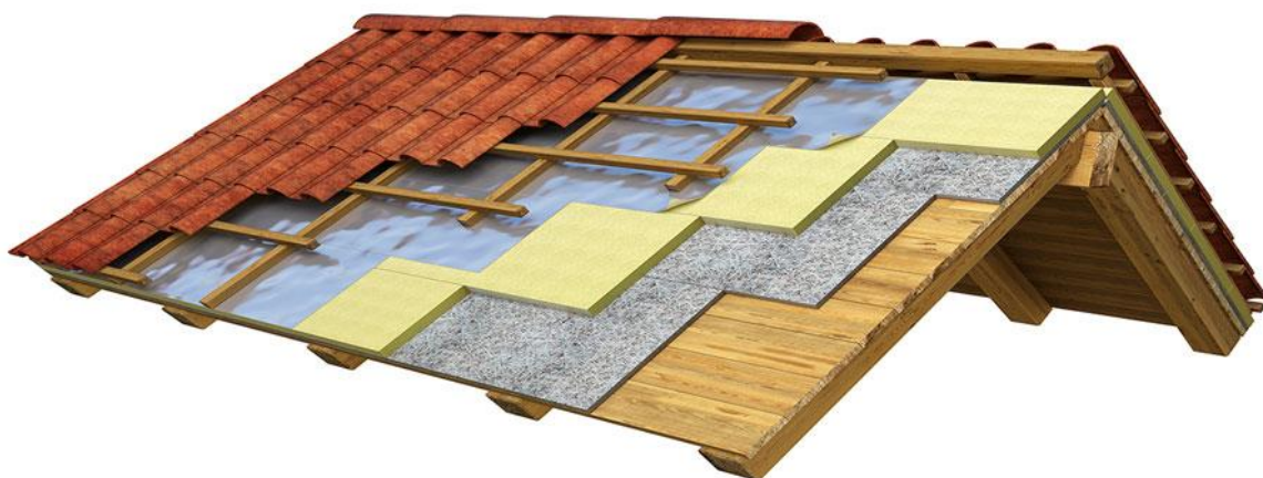
Kuvio 18. Katon lisälämmöneristys (Kattoremontti.pro, i.a).
