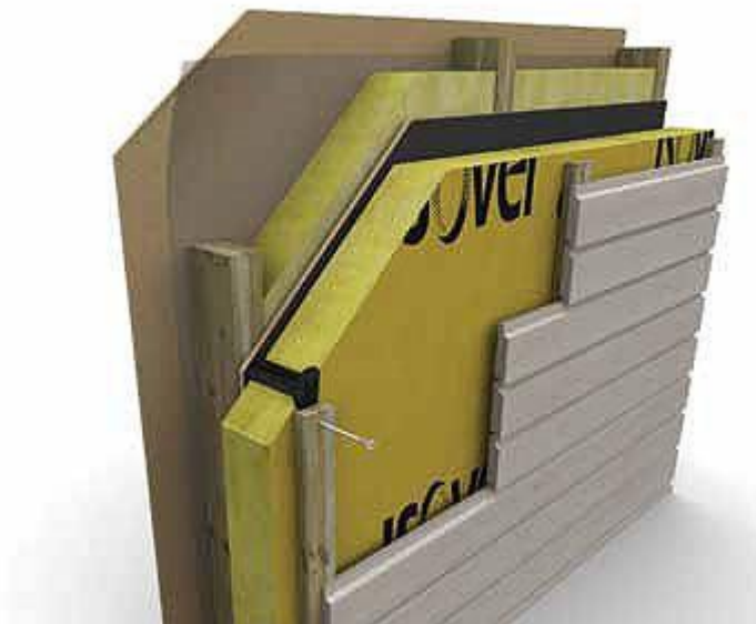
Kuvio 14. Lisälämmöneristys vanhaan seinään (Rakentaja.fi, 2013).
