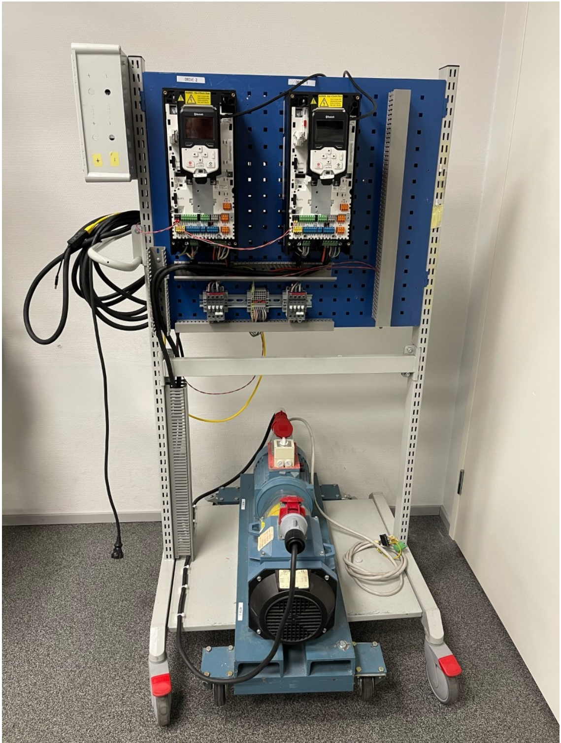
Testauslaitteisto ja ACS880-taajuusmuuttajat
