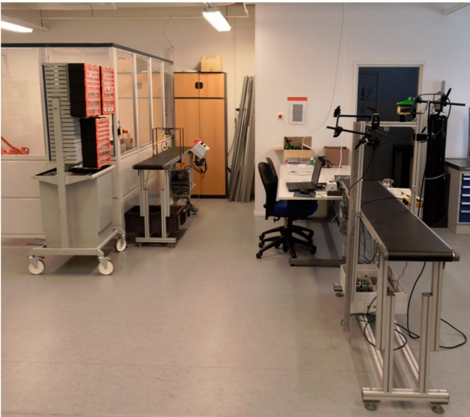
Kuva 10. Konenäön oppimisympäristö: etualalla älykamerapiste ja taustalla profiiliskanneri ja siihen liittyvä kuljetinhihna
