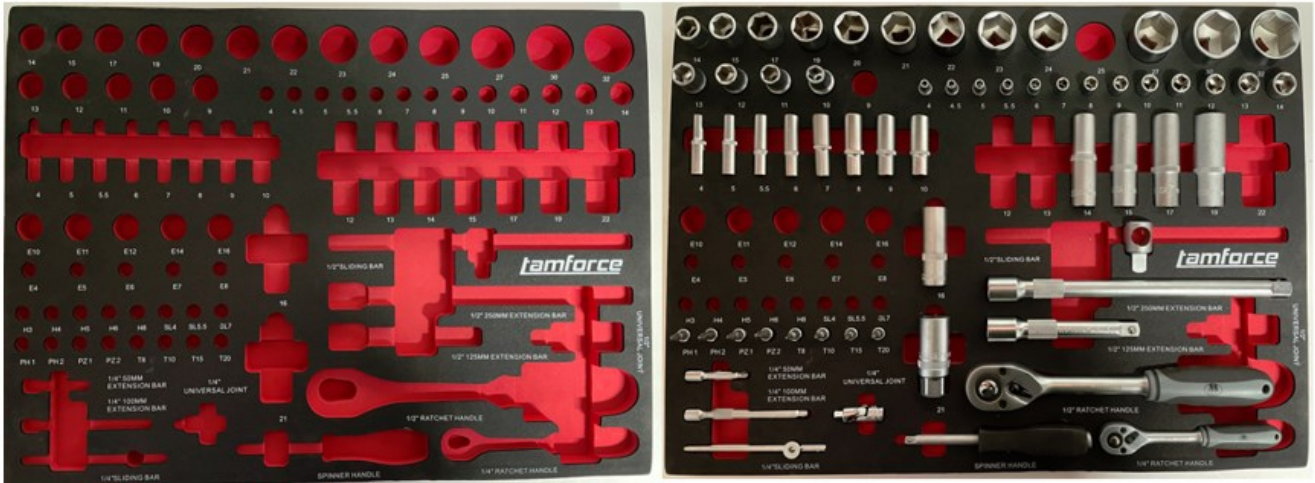
Kuva 2. Havaintokuva varjotaulusta, jossa kaksiväriseseen vaahtomuoviin on leikattu työkaluille omat paikkansa.
