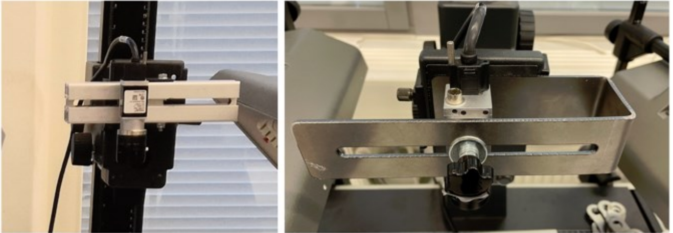
Kuva 30. Konenäköpisteen kameran kiinnitys ennen ja jälkeen muutoksen
