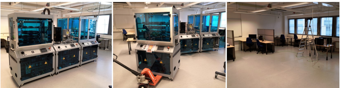
Kuva 13. Tuotantolinjaston siirrosta apuna käytettiin pumppukärryä
