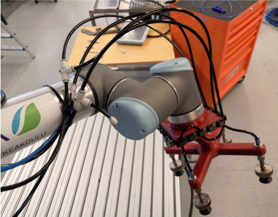
Kuva 23. Paineilmaliittimien käyttö robotin tarttujassa
