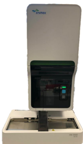
Kuva 1. Sysmex XN-1000 verenkuvaa-analysaattori
