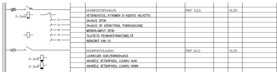
Kuva 25: Perinteisen kaapeloinnin keskuskaavio.
