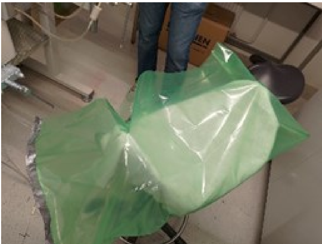
Kuva 3. Märkävalu tehtynä alipainesäkissä ennen imua.
