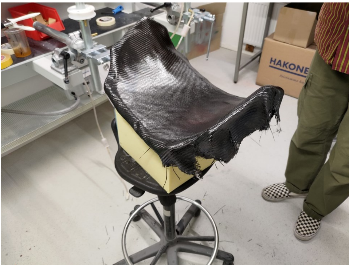
Kuva 11. Hiilikuitukankaat epoksilla siveltyinä Free Form -selkäosan päällä.
