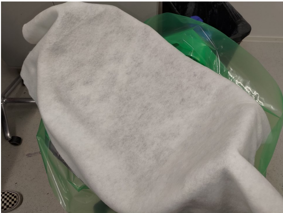
Kuva 10. Imuhuopa selkäosan päälle asetettuna ennen alipainesäkitystä.
