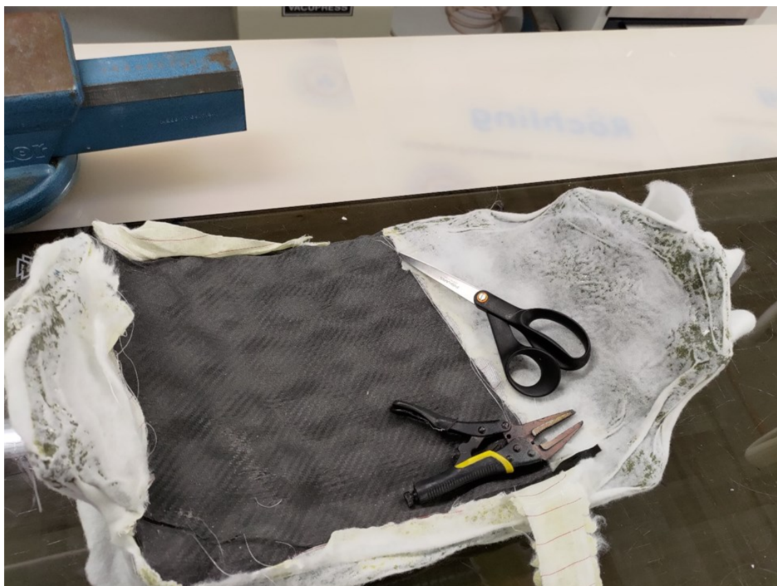
Kuva 9. Imuhuovan ja repäisykankaan irrottamista kovettuneesta hiilikuidusta.
