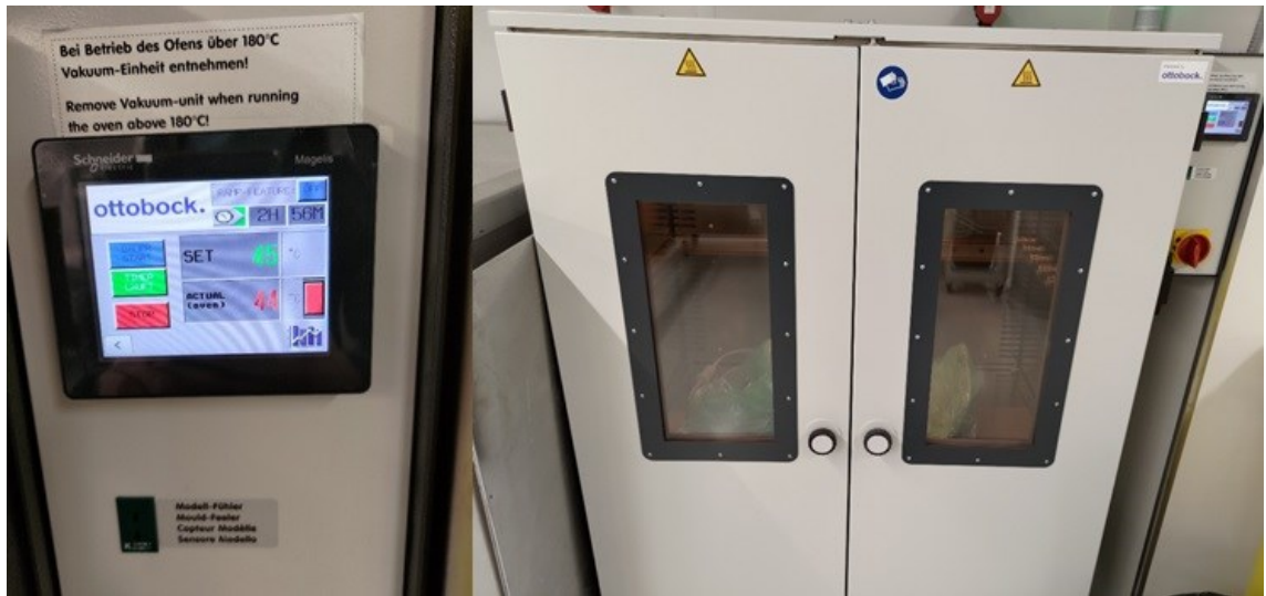
Kuva 13. Hiilikuidun jälkikovetusta uunissa.
