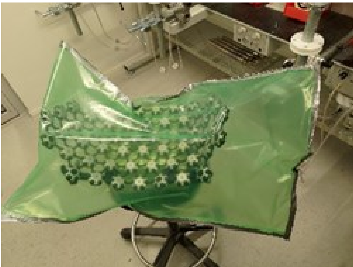
Kuva 2. Free Form -selkäosa alipainesäkissä.
