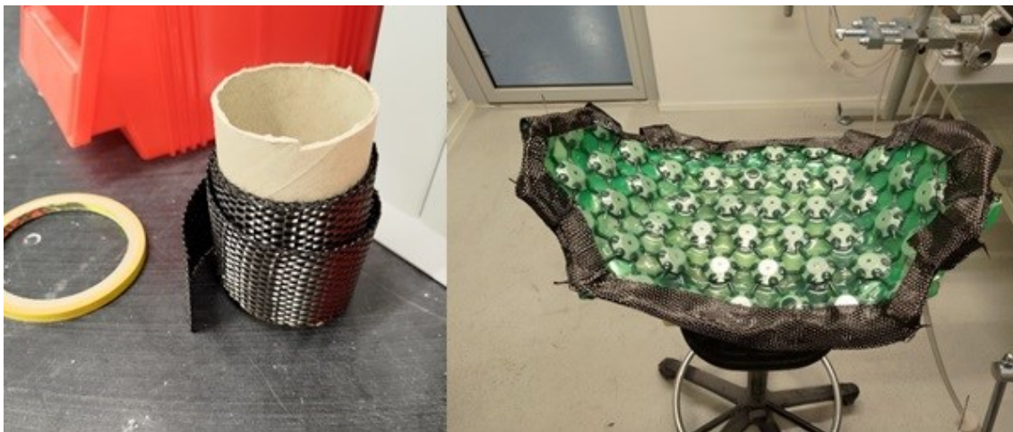
Kuva 6. Hiilikuitunauhaa asetettuna selkäosan reunoille.
