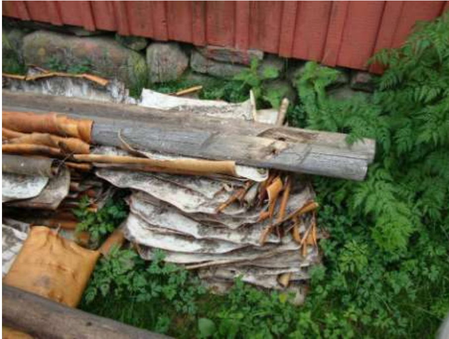
Kuva 8. Tuohilevyt ovat alkaneet käpristyä virheellisessä säilytyksessä.
