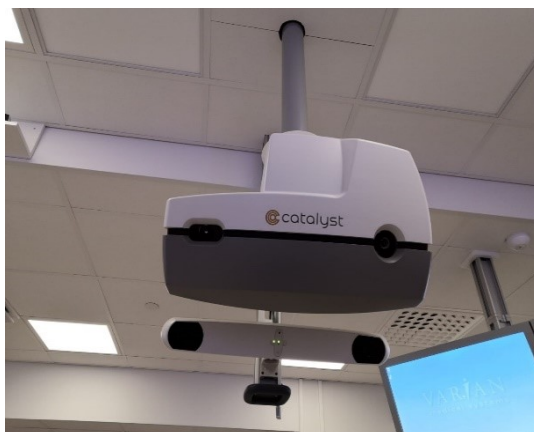
KUVA 4. ja 5. Catalyst®-pintatunnistejärjestelmän projektiyksikkö ja kolme kameraa sijoiteltuna kattoon hoitokoneen ympärille (Myller 2021, CC BY-SA).
