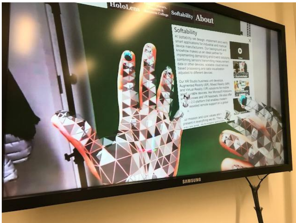
Kuva 2. Näyttöruudun kuvaa Microsoft HoloLens -käyttäjän näkymästä. HoloLens-lasit tunnistavat ja paikantavat käyttäjän kädet, joiden avulla voi antaa komentoja (Winogradow 2020a)
