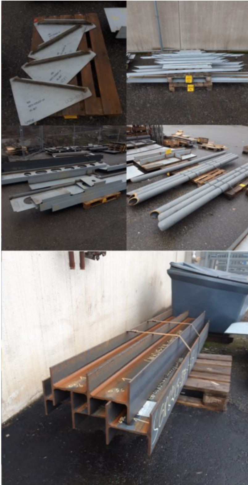
Kuva 4 Levy- ja profiiliosia, T-palkkeja, pilareita sekä H-palkkeja
