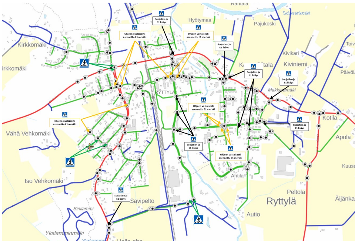
Kuva 31. Ryttylän taajaman suojateiden merkintöjen puutteet (muokattu, Väylävirasto, n.d.)
