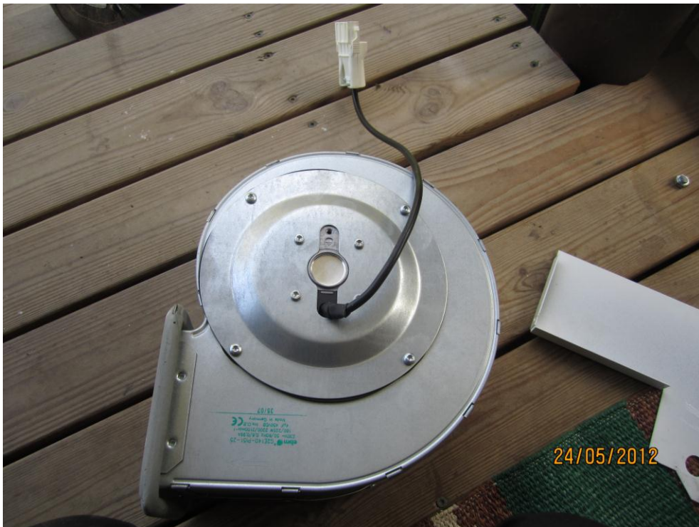
KUVIO 12. Puhallin ja kotelo irrotettuna yhtenä kappaleena
