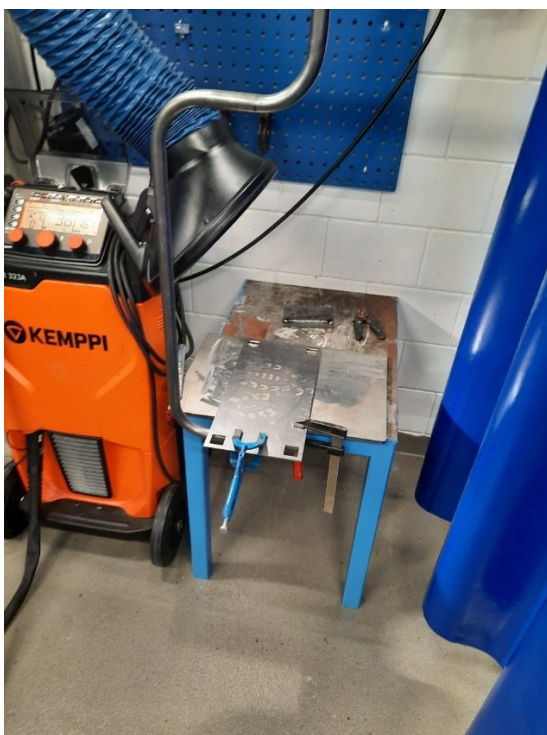
Kuva 10. Kiinnitys pöytään hitsaamista varten
