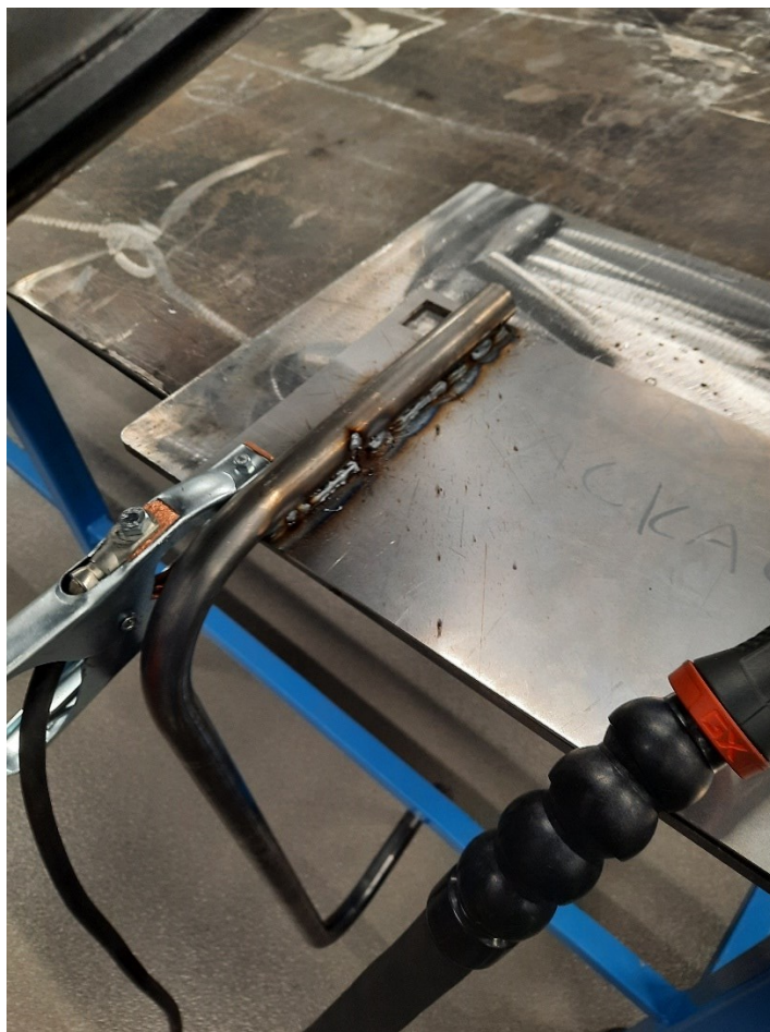
Kuva 12. Putken toinen puoli hitsattuna
