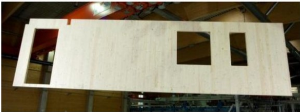
Kuvio 2. Asennusta vaille valmis runkoelementti.
