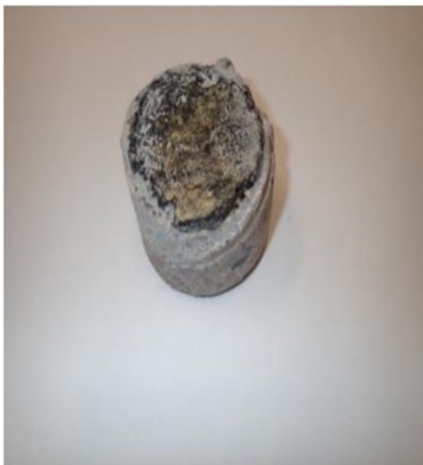
KUVA 8. Lattianäyte kosteista tiloista, ote raportista (Janhunen 2020, CC BY-NC-ND)
