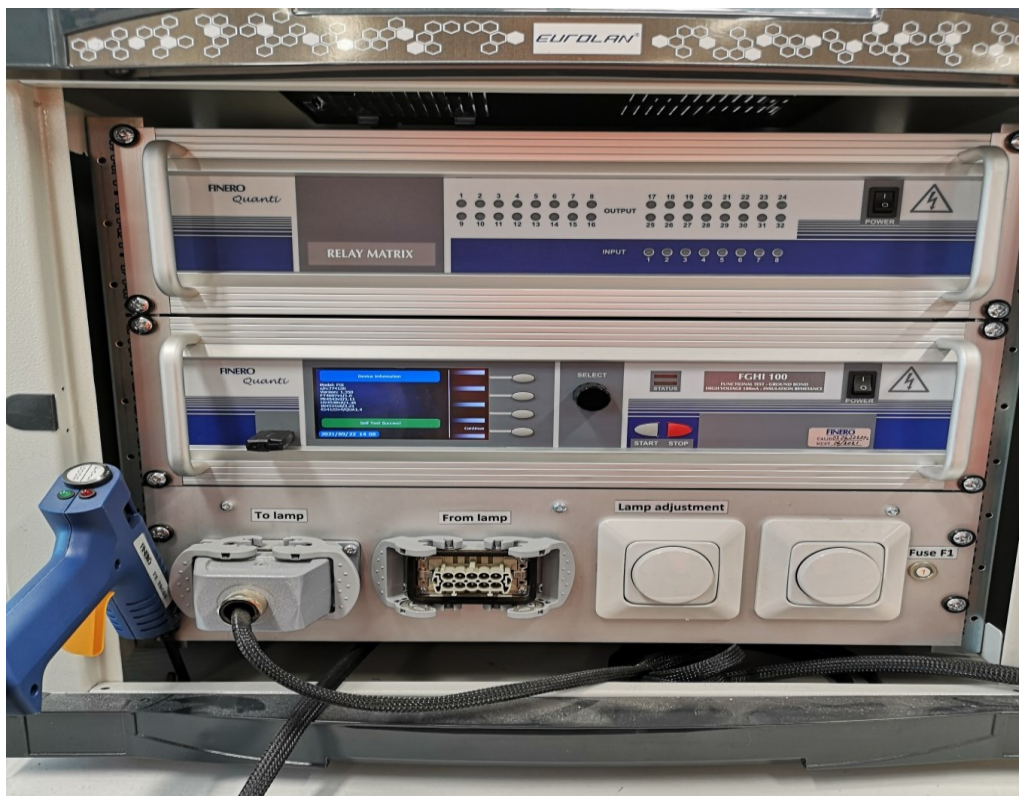
Kuva 2. Finero Oy:n valmistama sähköturvallisuusanalysointilaitteisto.
