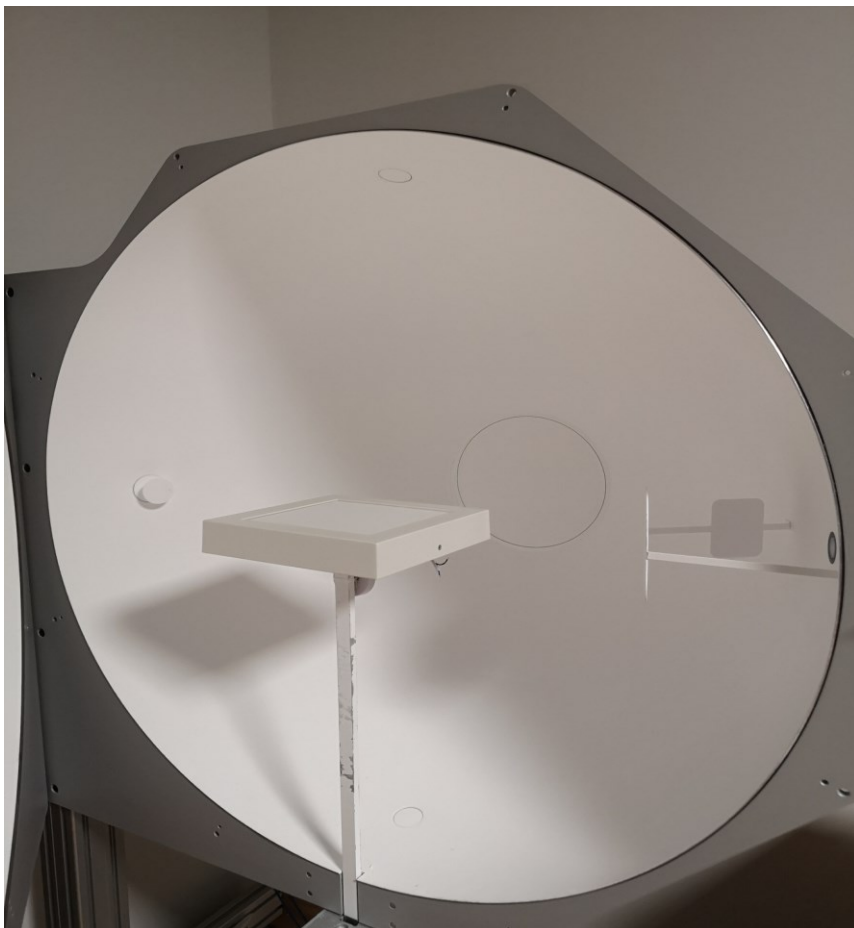
Kuva 7. Testattava valaisin integroivassa pallossa.
