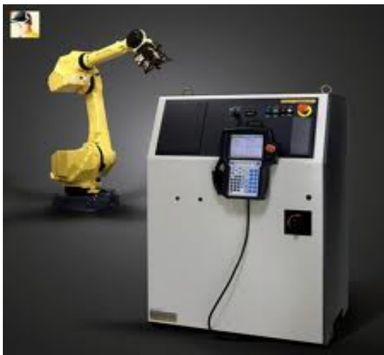
KUVA 2. Robotti ja hallintayksikkö (Robotics and automation)
