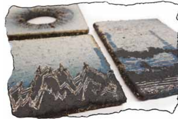
30. Raapetekniikalla ja kynäruiskulla kuvioituja koelaattoja
