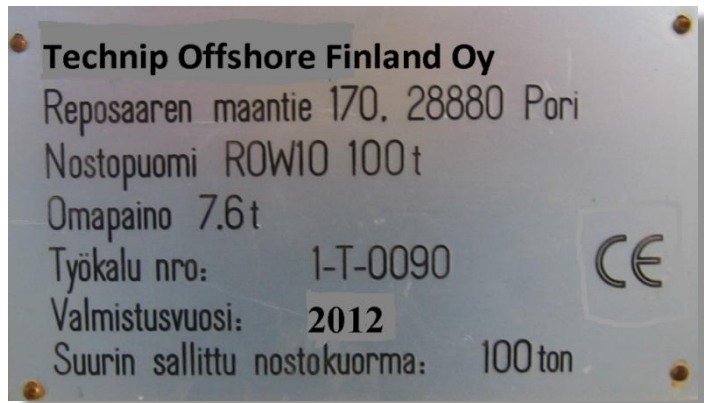
Kuva 6. Kuvassa on CE-merkintä mallin tyyppikilpi (Vanhasta muokattu malliksi)
