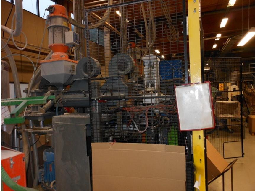
Kuva 7. Plastiblow-puhallusmuovauskone (kuvaaja Kenneth Oldenburg 2012)
