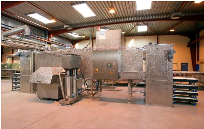
Kuva 9. Laatikoiden pesuun käytetään tunnelin mallisia pesukoneita. (Brüel, 2012.)
