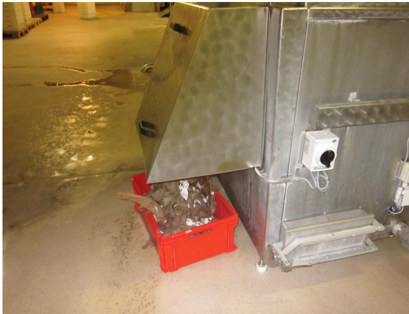
Kuva 10. Roskanpoistorummun avulla pesuteho säilyy parempana ja vesisuuttimet pysyvät paremmin auki.
