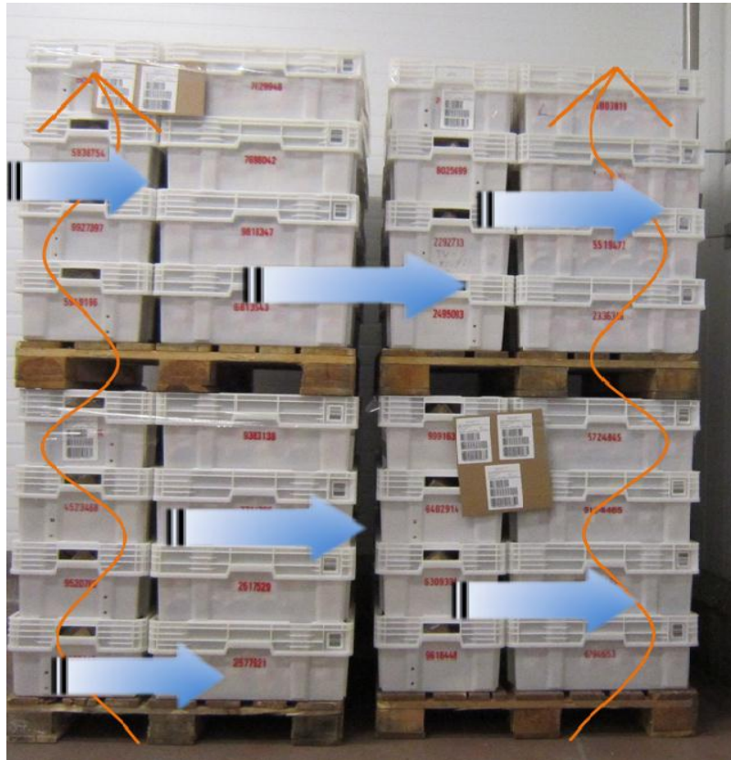
Kuva 1. Kuormauksessa käytettävien lavojen ja laatikoiden tulee olla rakenteeltaan sellaisia, että ilma kiertää koko kuormatilan pituudelta. Ilman on pystyttävä kulkemaan myös kuorman välissä. EUR – ja FIN- lavat mahdollistavat ilman kierron myös alhaalta ylöspäin.
