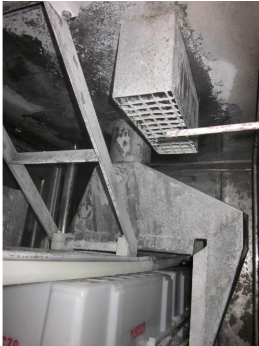
Kuva 11. Liimasta, tarroista, pahvista ja veden kalkista muodostuva sementtimäinen massa oli erittäin vaikea poistaa laatikkopesukoneen rosterisilta pinnoilta.
