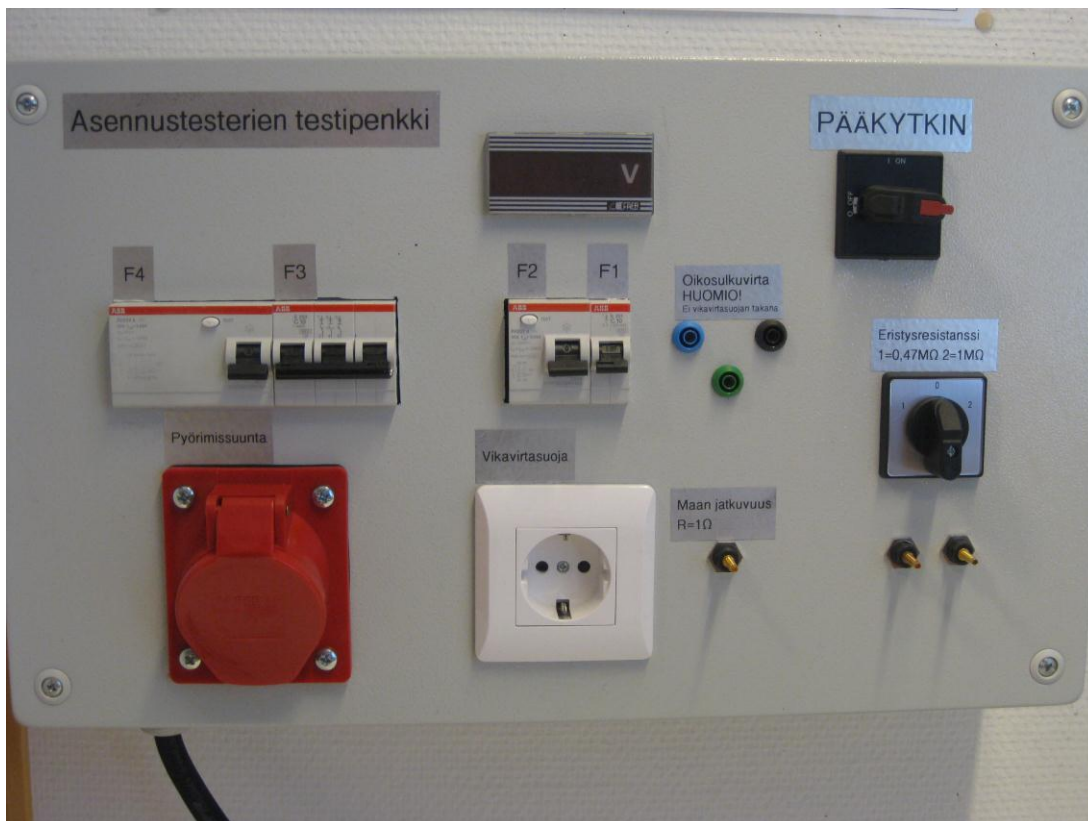
Kuva 11. Testipenkki jälkiasennetun jännitemittarin kanssa
