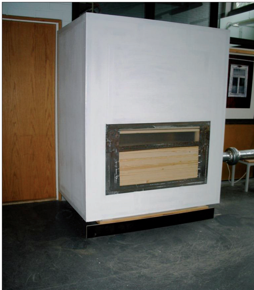
Kuvio 4. Varausten tiiviysmittaukset tehtiin painekaapin avulla
