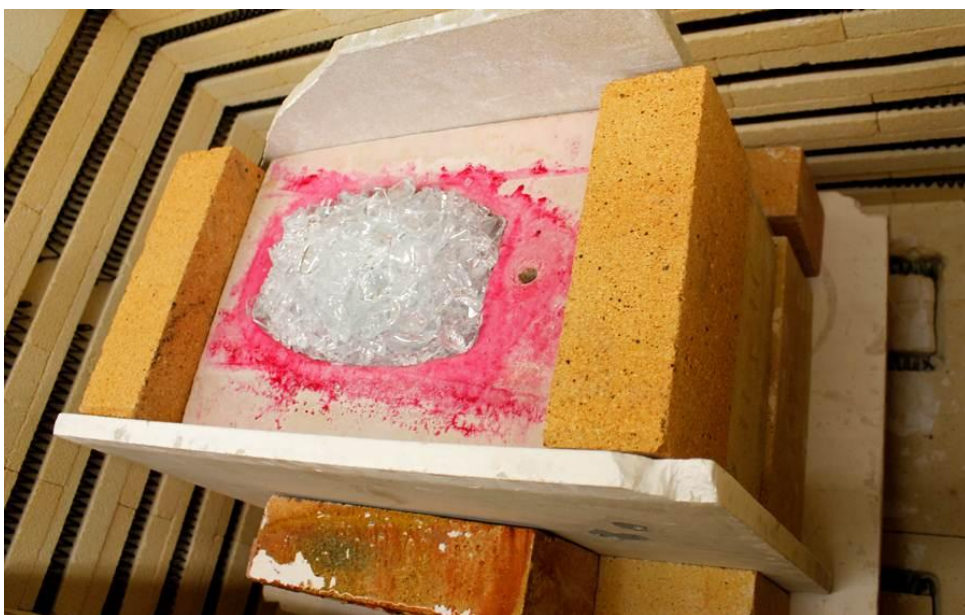
KUVA 27 Lasin valumuotti täytettynä lasimurskalla ja lastattuna sulatusuuniin.
