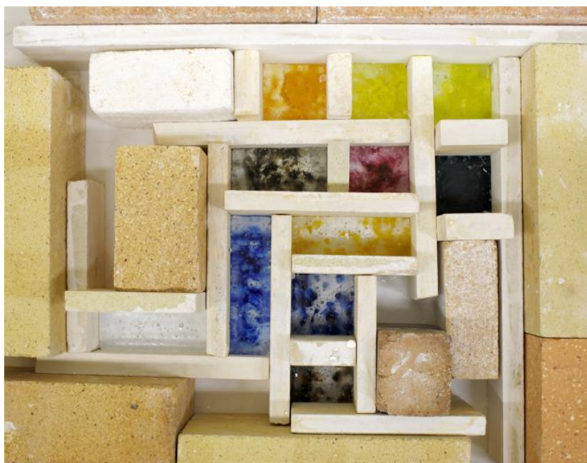
KUVA 15 Sulatetut koekuutiot uuniin rakennettujen kehikkojen sisällä.
