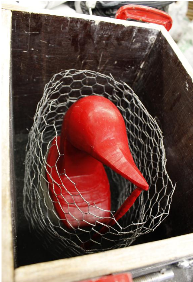
KUVA 25 Punavahamalline rajoittimien keskellä ja ympäröitynä kanaverkolla.
