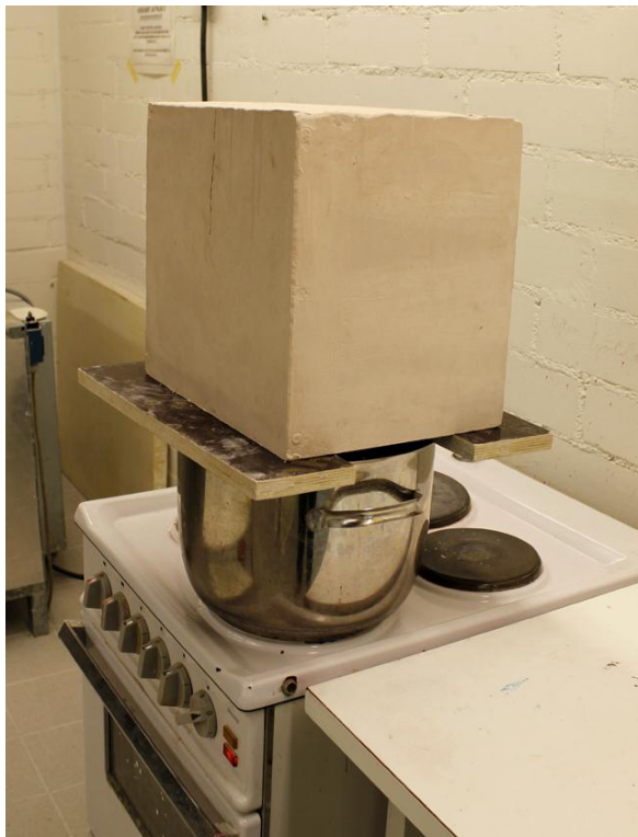
KUVA 26 Kipsimuotti kiehuvan vesikattilan päällä, jotta punavaha sulii pois muotin sisältä.
