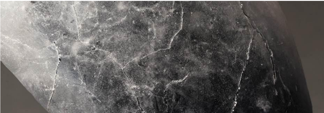
KUVA 28 Muotin halkeilusta syntyneet kuviot lasin pinnassa.
