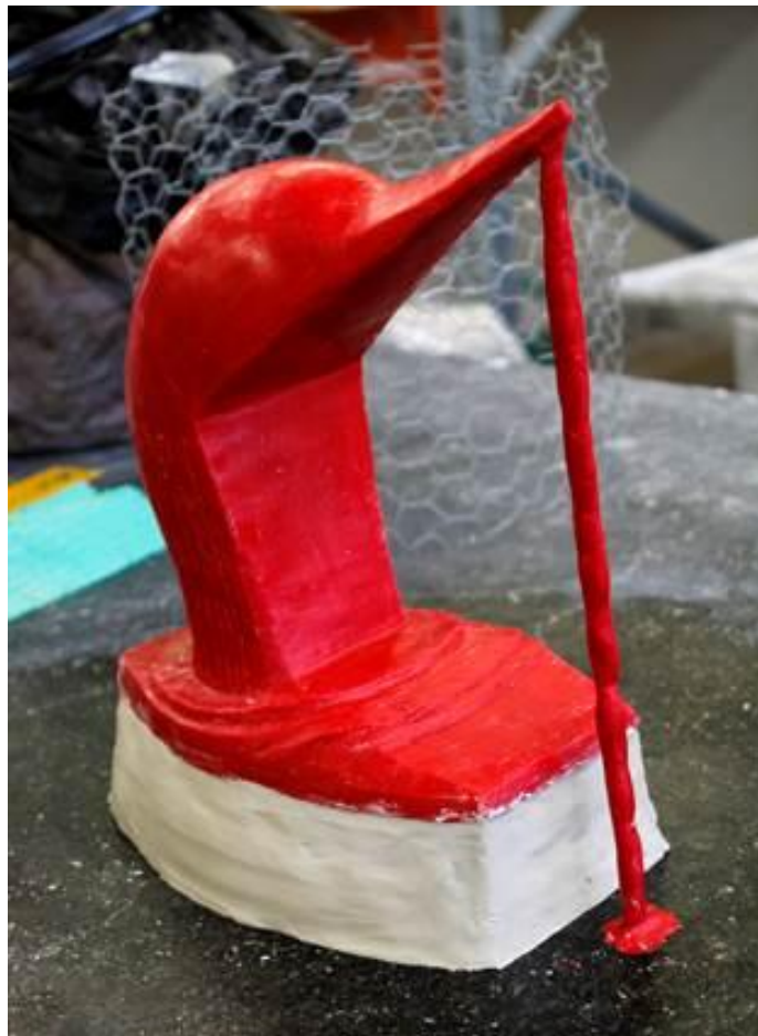
KUVA 24 Ilma-aukko ja muotin täyttöaukon savimalline kiinnitettynä punavahamallineeseen.
