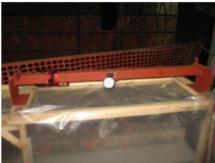
Kuva 5 Taipumakutistuman mittausteline ja –kello
