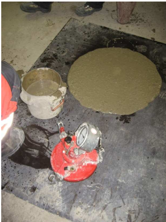
Kuva 9. Oikealla betonin leviämästä muodostunut leviämäalue ja vasemmalla ilmamäärän mittauslaite
