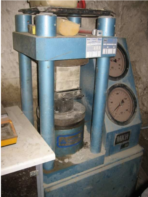
Kuva 13. Puristuslujuuden mittaaminen 150 mm sivumitoiltaan olevasta betonista
