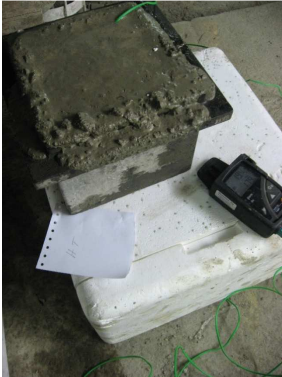
Kuva 14. HT betonin yhden vuorokauden lämpötilamittauskoekappale ja lämpötila-dataloggeri
