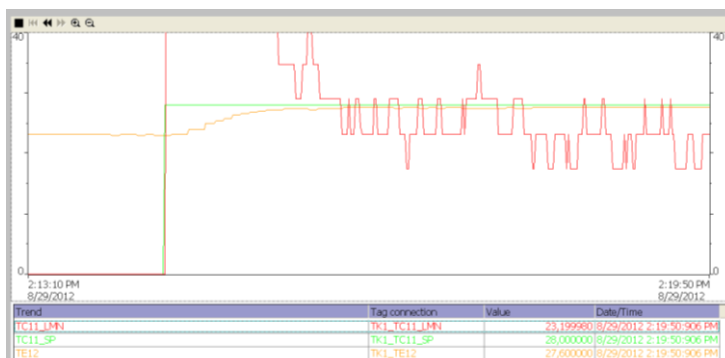
Kuva 34. Jälkilämmityspatterin viritetty P-säätö.
