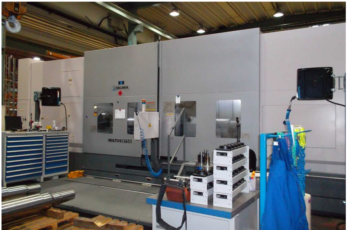
KUVA 6. Uusi työstökeskus Okuma Multus B750
