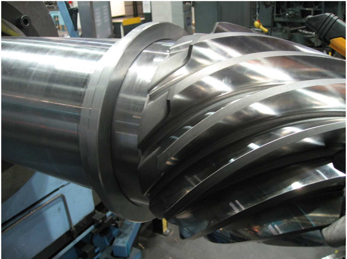
KUVA 7: Teräsholkki pinionin viimeistellyllä kaulalla
