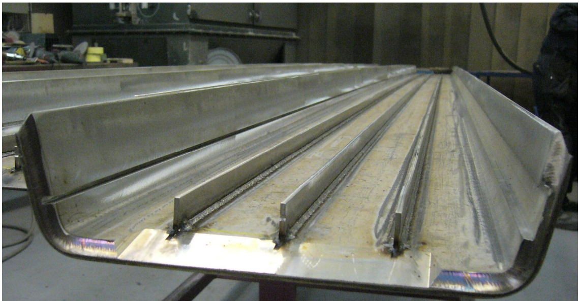
Kuvio 7. Vaippakouruun on hitsattu koneistettuihin keskiuriin kolme vahvistelevyä
