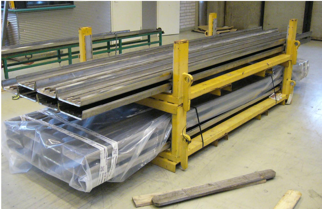
Kuvio 12. Kaksi kuljetusyksikköä on pakattu päällekkäin. Alemmassa yksikössä on 12 kpl kouruja ja ylempässä 6 kpl kouruja.
