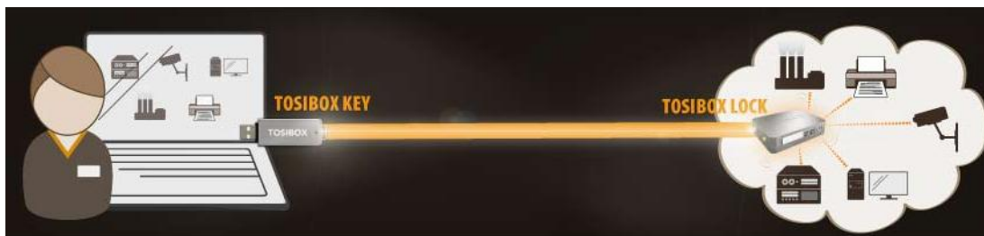
Kuva 12. Tosiboxin perustoimintakaavio. (Tosibox Oy.)
