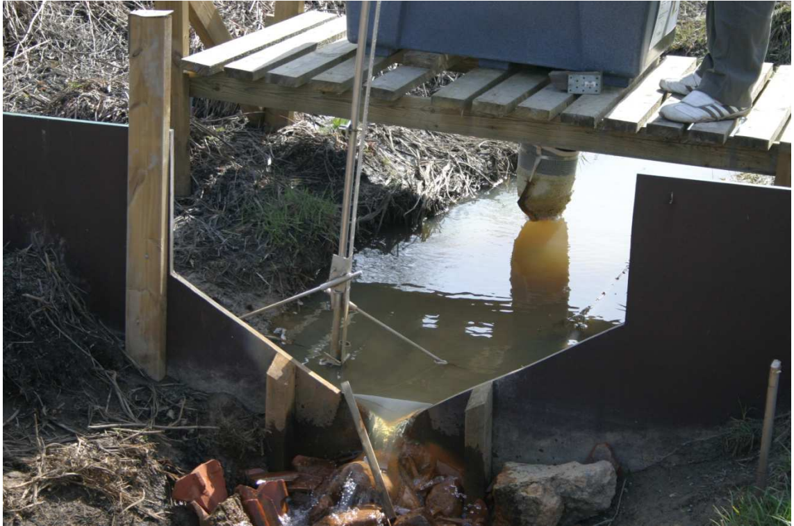
Kuva 3. Kemikaalinannostelija, pinnankorkeusmittari ja V-pato (Laura Lepistö).
