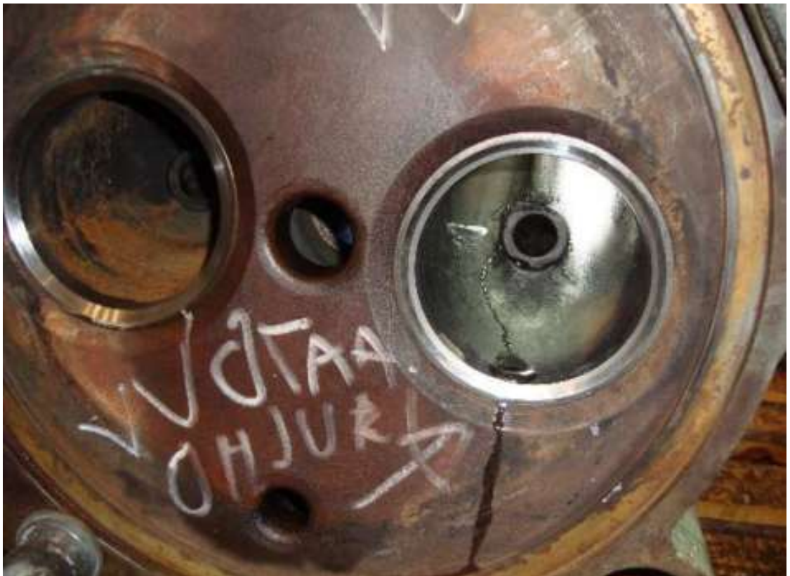
Kuva 8. Vaihtoon mennyt vuotava apukoneen kansi. (Wärtsilä 2012.)
