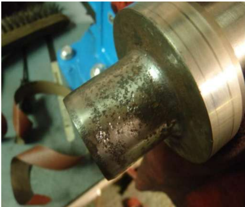
kuva 11. Vesipumpun korroosiota kärsinyt akseli puhdistuksen jälkeen.
