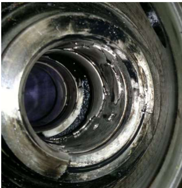
Kuva 4. AK-2:n vesipumpun vanha laakeri (Wärtsilä 2012).
