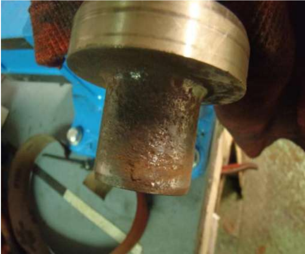
Kuvat 10. Vesipumpun korroosiota kärsinyt akseli ennen puhdistusta
