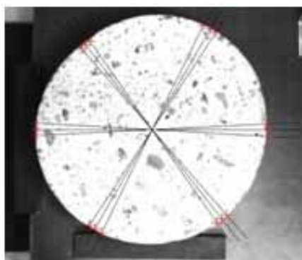
Kuva 4. Betonikappaleesta mitattavat dimensiot.
