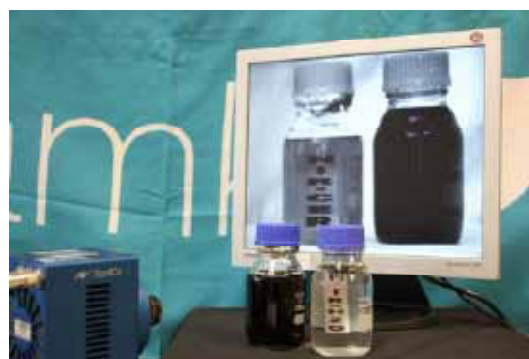
Kuva 1. Vesi ja kerosiinipohjainen aine näkyvät erilaisina lähi-infrapunakameralla otetussa kuvassa ja näkyvän valon aallonpituusalueella toimivalla kameralla otetussa kuvassa.
