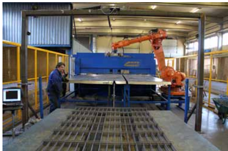
Kuva 12. Rauditusverkkoja menossa leikkaussolun robotin käsittelyyn Pintoksella.
