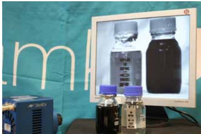
Kuva 9. Vesi ja kerosiinipohjainen aine näkyvän valon aallonpituusalueen kuvassa (etualalla) ja NIR-kuvassa (näytöllä, taka-alalla).
