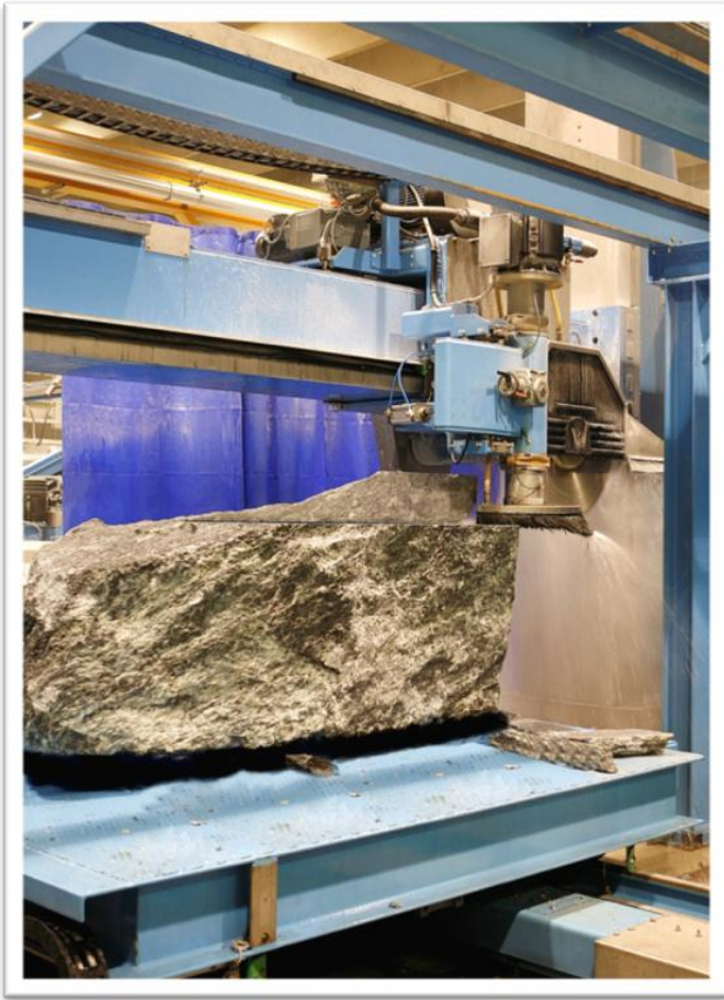
KUVA 3. Vauhkonen, H. 2012. Block-Cutter sahaus. PowerPoint-diasarja. Presentaatio 1. Tulikivi.
