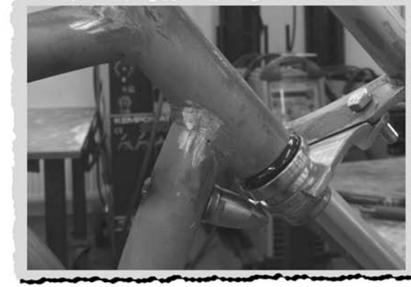
57. Emäputki ja alaputki vaihdettuna. 59. Ohjauksenrajoitin kasattuna.
