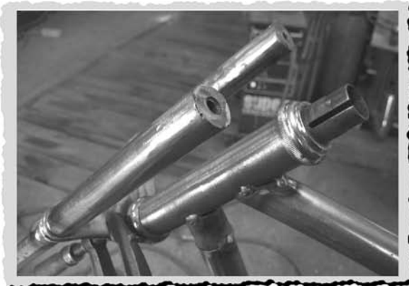
48. Etuhaarukan osat 50. Ylä T -kappaleen kiinnitys
