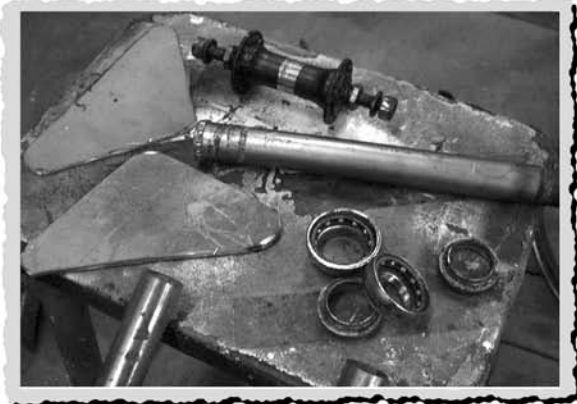
48. Etuhaarukan osat 50. Ylä T -kappaleen kiinnitys
