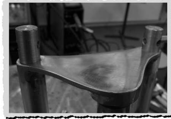
61. Ohjaustangon kiinnitys haarukkaan. 63. Valmiit luotipultit ja aluslevyt.
