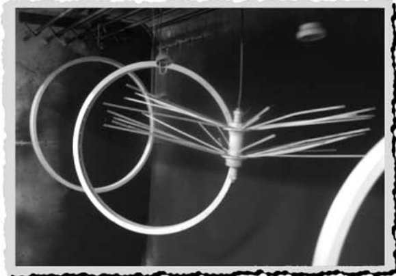
52. Vanteet, pinnat ja navat pulverimaalattiin. 54. Korvakkeet viimeisteltynä
