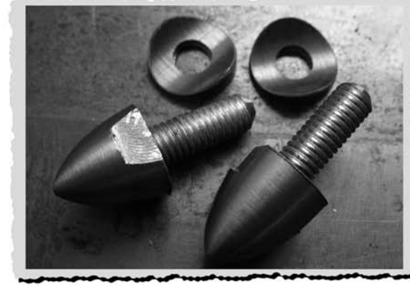
61. Ohjaustangon kiinnitys haarukkaan. 63. Valmiit luotipultit ja aluslevyt.
