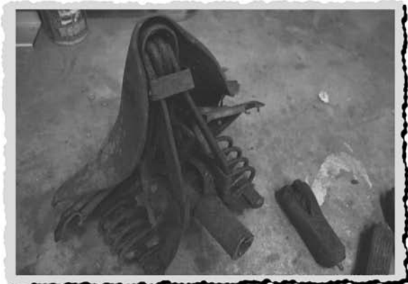
64. Vanha satula otettiin uusiokäyttöön. 66. Pinnapulttit hitsattuna jousille.
