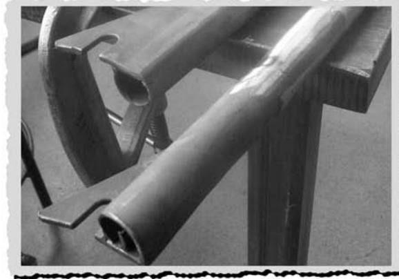
49. Etuhaarukan korvakkeet hitsattuna. 51. Tankoa varten tehtiin toinen T -kappale.
