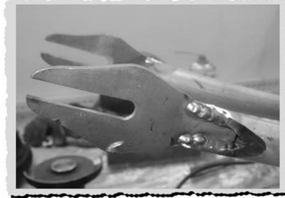
53. Korvakkeitten hitsaus 55. Uuden haarukan osat kasausta vailla.
