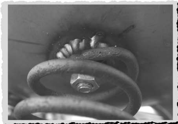
64. Vanha satula otettiin uusiokäyttöön. 66. Pinnapulttit hitsattuna jousille.
