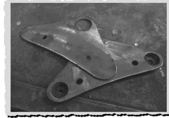
49. Etuhaarukan korvakkeet hitsattuna. 51. Tankoa varten tehtiin toinen T -kappale.
