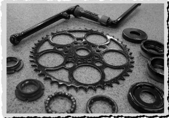
70. ja 71. Pulverimaalatut osat kasausta vaille. 72. Etuhaarukka pulverointikaapissa.
